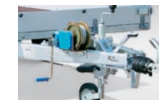
V-drawbar with jockey wheel Attelage en V avec roue jockey V-dissel met neuswiel
