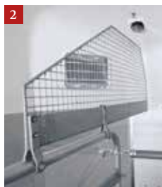
Hovedskillevæg i aluminium til transport af to hingste (1) eller en gitterhovedskillevæg (2) Mellanvägg med huvudskydd av aluminium för transport av två hingstar (1) eller en gallervägg med huvudskydd (2)
